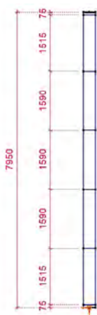
Rys. 3. Model dyskretny słupa wspornikowego i jego widok 3D zrenderowany w programie AxisVM
